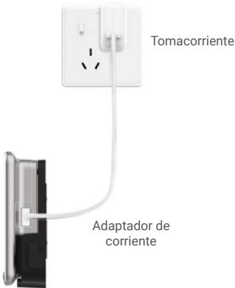
Conecte el panel al tomacorriente mediante un adaptador de corriente (5V 2A, se vende por separado).
