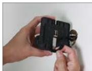
Saque la base e inserte el conector en la ranura en la parte inferior de la base.
