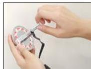
Ajuste los tornillos en la parte trasera de la cámara.
