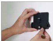
Pase los tornillos a través de los orificios de montaje.
